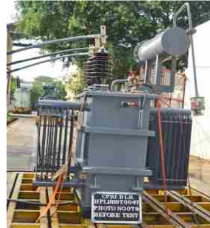
मेसर्स ओमान इंडस्ट्रीस ट्रांसफार्मर्स एंड स्विचगियर, ओमान सल्तनत के लिए उच्च शक्ति प्रयोगशाला, सी पी आर आई, बेंगलूर में 315 के वी ए, 33/0.433 के वी. त्रिकलीय परिणामित्र पर लघु परिपथ परीक्षणों के गतिक प्रभावों के सहन करने का सामर्थ्य।
