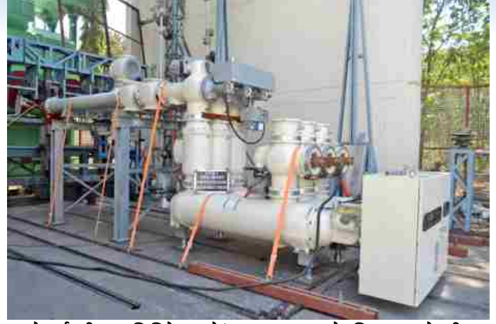
मेसर्स सीमन्स लिमिटेड, औरंगाबाद, महाराष्ट्र के लिए 245 के वी, 3150 ए, 50 के ए जी आई एस पर लघु कालीन सहन धारा परीक्षण ।
