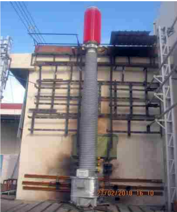
मेसर्स ए बी बी इण्डिया लिमिटेड, वडोदरा के लिए 800 के वी, 500 - 1000-2000-3000/ 1-1-1 ए, धारा परिणामित्र पर 125 के ए के प्रारंभिक शिखर युक्त 3 सेकंड के लिए 50 के ए आर एम एस पर लघुकालीन धारा परीक्षण ।
