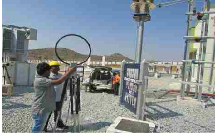
400/220 के वी, पी जी सी आई एल उपकेंद्र, एन पी कुंठा, अनंतपुर, आंध्र प्रदेश के लिए 100 एम वी ए आर, स्टेड्कॉम युनिट के आस पास रेडियो व्यतिकरण वोल्टता (आर आई वी) का मापन ।
