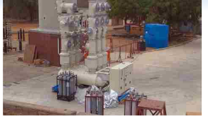
यू एच वी आर एल-सी पी आर आई, हैदराबाद में मेसर्स सीमन्स लिमिटेड, आंरगाबाद के लिए 420 के वी, जी आई एस पर सम्पन्न तडित आवेग वोल्तता सहन परीक्षण और स्विचन आवेग वोल्तता सहन परीक्षण ।
