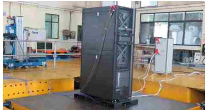
मेसर्स इनाडर इलेक्ट्रिक आई टी बिज़नेस प्राइवेट लिमिटेड, फिलिपाइन्स के लिए भूकंप इंजीनियरी व कंपन अनुसंधान केंद्र, सी पी आर आई, बेंगलूर में स्मार्ट यू पी एस 20 के वी ए पर संपन्न भूकंपी परीक्षण।
