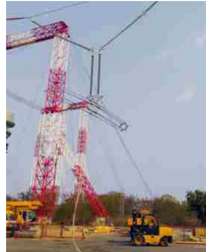
मेसर्स डेक्कन एंटरप्राइजेस लिमिटेड, हैदराबाद के लिए \pm 800 के वी एच वी डी सी एकल "Y" निलंबन संयोजित लम्बे छड पर तडित आवेग वोल्टता सहन परीक्षण और आर्द्र स्विचन आवेग वोल्टता सहन परीक्षण ।
