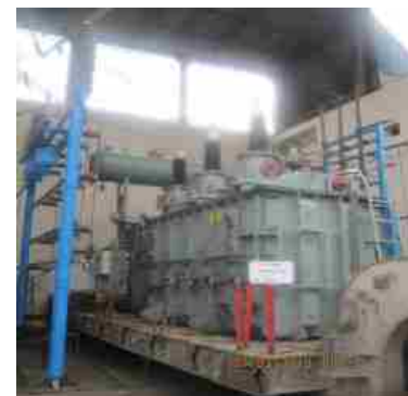
मेसर्स टेक्नीकल एसोसिएट लिमिटेड, सितारगंज के लिए एस टी डी एस - सी पी आर आई, भोपाल में 25/31.5 एम वी ए, 66/11 के वी विद्युत परिणामित्र पर आई एस 2026 (भाग 5), 2011 के खंड 4.2 के अनुसार लघु परिपथ गतिक सहन परीक्षण सम्पन्न ।
