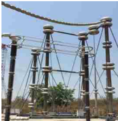
मेसर्स ई एम आई ट्रांसमिशन लिमिटेड, मुम्बई के लिए यू एच वी आर एल – सी पी आर आई, हैदराबाद में छः बंडल लैपविंग ए सी एस आर चालक के लिए \pm 800 के वी, प्रतिधारक छडों वाले अंतरक अवमंदक पर डी सी आर आई वी परीक्षण तथा डी सी कोरोना परीक्षण सम्पन्न ।
