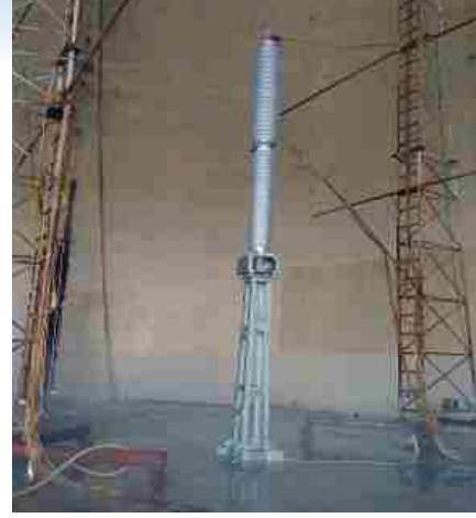
यूएचवीआरएल-सीपीआरआई, हैदराबाद में मेसर्स सीमन्स लिमिटेड, औरंगाबाद के लिए 245 केवी सम्मिश्र विद्युत रोधक वाले एकल ध्रुव परिपथ विच्छेदक पर लवण कुहरा प्रणाली द्वारा प्रदूषण परीक्षण
