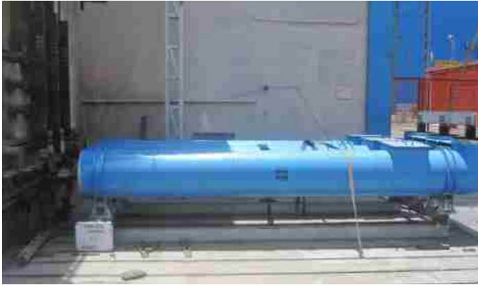
मेसर्स बीएचईएल, रुद्रापुर के लिए एसटीडीएस-सीपीआरआई, भोपाल में संपन्न 11 केवी, 4000ए, 90 के ए आर एम एस बस डक्ट पर आई एस: 8084 के अनुसार 230 केए के प्रारंभिक शिखर के साथ एक सेकंड के लिए 90 के ए आर एम एस पर लघु कालीन सहन धारा परीक्षण संपन्न ।
