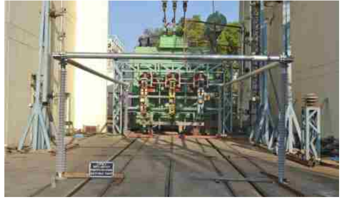
मेसर्स डेक्कन एंटरप्राइजेस लिमिटेड, हैदराबाद के लिए 220 के वी निर्धार के उपकेंद्र पश्च विद्युत रोधक पर लघु कालीन सहन धारा परीक्षण ।
