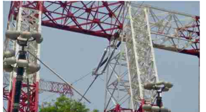
मेसर्स डेक्कन एंटरप्राइजेस लिमिटेड, हैदराबाद के लिए यूएचवीआरएल – सी पी आर आई, हैदराबाद में 400 के वी, पालीमर विद्युत रोधी तार पर तडित आवेग वोल्टता सहन परीक्षण तथा विद्युत आवृत्ति वोल्टता सहन परीक्षण संपन्न ।
