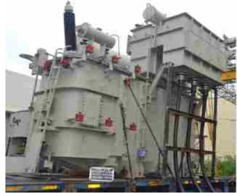
मेसर्स ट्रांसफॉर्मर्स एंड रेक्टिफायर्स लिमिटेड, अहमदाबाद के लिए उच्च शक्ति प्रयोगशाला, सी पी आर आई, बैंगलूर में 25 एमवीए, 110/33 केवी त्रिकलीय परिणामित्र पर लघु परिपथ परीक्षण के गतिक प्रभावों को सहन करने का सामर्थ्य
