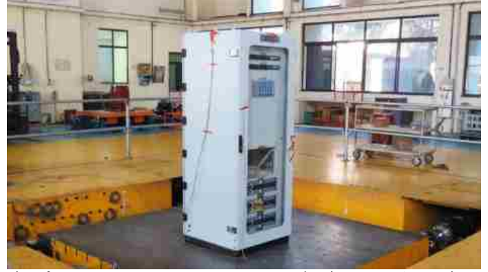
मेसर्स अल अहलिया स्विचगियर कम्पनी, कुवैत के लिए एकीकृत मोटर नियंत्रण प्रणाली का भूकम्पी परीक्षण।
