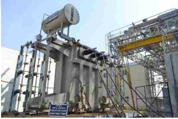
मेसर्स शिल्चर टेकनालॉजीस लिमिटेड, वडोदरा के लिए 5 एम वी ए, 33 के वी / 0.360-0.360 के वी पर लघु परिपथ परीक्षण के गतिक प्रभावों को सहन करने का सामर्थ्य ।
